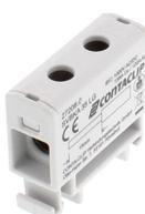
Schraub-Verteiler-Block, Schraubanschluss, Montageart: TS 35/7,5 und Montagefläche, Bemessungsquerschnitt Eingang: 35 mm<sup>2</sup>, Bemessungsquerschnitt Ausgang: 35 mm<sup>2</sup>, Farbe: Lichtgrau
