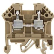
Durchgangsklemme, Schraubanschluss, Montageart: TS 35/7,5 und TS 32, Bemessungsquerschnitt: 4 mm<sup>2</sup>, Breite: 6 mm, Farbe: Beige
