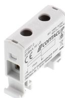
Schraub-Verteiler-Block, Schraubanschluss, Montageart: TS 35/7,5 und Montagefläche, Bemessungsquerschnitt Eingang: 16 mm<sup>2</sup>, Bemessungsquerschnitt Ausgang: 16 mm<sup>2</sup>, Farbe: Lichtgrau
