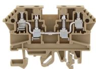
Durchgangsklemme, Schraubanschluss, Montageart: TS 35/7,5 und TS 32, Bemessungsquerschnitt: 4 mm<sup>2</sup>, Breite: 6 mm, Farbe: Beige
