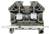
Durchgangsklemme, Schraubanschluss, Montageart: TS 35/7,5, Bemessungsquerschnitt: 4 mm<sup>2</sup>, Breite: 6 mm, Farbe: Beige
