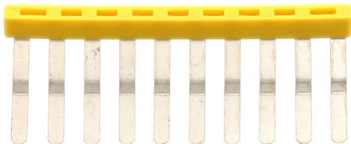
Aussenquerverbinder isoliert, Polzahl: 10, Montageart: Stecken, Breite: 50,1 mm, Bemessungsstrom: 27 A,
