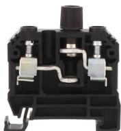
Sicherungsklemme mit Schraubkappe für Kennmelder Sicherungen 5x25 mm, Schraubanschluss, Montageart: TS 35/7,5, Bemessungsquerschnitt: 10 mm<sup>2</sup>, Breite: 12,2 mm, Farbe: Schwarz
