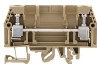
Prüftrennklemme, Schraubanschluss, Montageart: TS 35/7,5 und TS 32, Bemessungsquerschnitt: 10 mm<sup>2</sup>, Breite: 8 mm, Farbe: Beige
