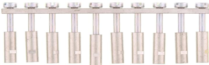
Querverbinder, Polzahl: 10, Montageart: Schraubbar, Breite: 78,9 mm, Bemessungsquerschnitt: 10 mm<sup>2</sup>,
