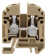
Durchgangsklemme, Schraubanschluss, Montageart: TS 15/5,5, Bemessungsquerschnitt: 4 mm<sup>2</sup>, Breite: 6 mm, Farbe: Beige
