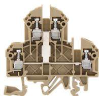
Doppelstockklemme, Schraubanschluss, Montageart: TS 35/7,5 und TS 32, Bemessungsquerschnitt: 2,5 mm<sup>2</sup>, Breite: 5 mm, Farbe: Beige
