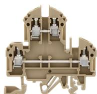
Doppelstockklemme, Schraubanschluss, Montageart: TS 35/7,5 und TS 32, Bemessungsquerschnitt: 4 mm<sup>2</sup>, Breite: 6 mm, Farbe: Beige
