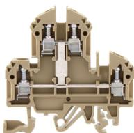
Doppelstockklemme, Schraubanschluss, Montageart: TS 35/7,5 und TS 32, Bemessungsquerschnitt: 4 mm<sup>2</sup>, Breite: 6 mm, Farbe: Beige
