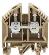
Durchgangsklemme, Schraubanschluss, Montageart: TS 35/7,5 und TS 32, Bemessungsquerschnitt: 16 mm<sup>2</sup>, Breite: 12 mm, Farbe: Beige
