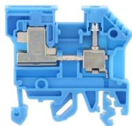
Neutralleiter-Trennklemme, Schraubanschluss, Montageart: TS 35/7,5 und TS 32, Bemessungsquerschnitt: 4 mm<sup>2</sup>, Breite: 6 mm, Farbe: Blau
