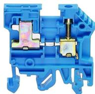
Neutralleiter-Trennklemme, Schraubanschluss, Montageart: TS 35/7,5 und TS 32, Bemessungsquerschnitt: 4 mm<sup>2</sup>, Breite: 6 mm, Farbe: Blau
