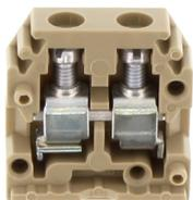
Ex-Durchgangsklemme z. Direktmont. Zertif. n. ATEX, Schraubanschluss, Montageart: Montagefläche, Bemessungsquerschnitt: 4 mm<sup>2</sup>, Breite: 6 mm, Farbe: Beige
