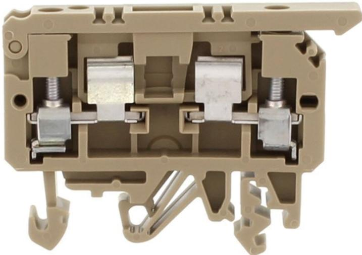
Sicherungstrennklemme, Schraubanschluss, Montageart: TS 35/7,5 und TS 32, Bemessungsquerschnitt: 4 mm<sup>2</sup>, Breite: 8 mm, Farbe: Beige
