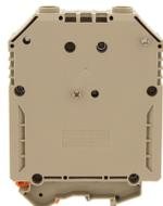
Durchgangsklemme, Schraubanschluss, Montageart: TS 35/7,5 und TS 32, Bemessungsquerschnitt: 240 mm<sup>2</sup>, Breite: 36 mm, Farbe: Beige
