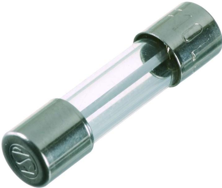
Sicherungselement, Abmessung: 5x20 mm, Aulösecharakteristik: Flink (F); Bemessungsspannung: 250 V, Bemessungsstrom: 1 A
