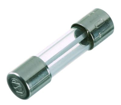
Sicherungselement, Abmessung: 5x20 mm, Aulösecharakteristik: Flink (F); Bemessungsspannung: 250 V, Bemessungsstrom: 6.3 A
