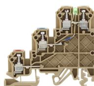
Dreistock-Initiatorenklemme, Schraubanschluss, Montageart: TS 35/7,5 und TS 32, Bemessungsquerschnitt: 2,5 mm<sup>2</sup>, Breite: 5 mm, Farbe: Beige
