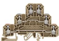
Dreistock-Initiatorenklemme|Mehrleiterklemme, Schraubanschluss, Montageart: TS 35/7,5 und TS 32, Bemessungsquerschnitt: 2,5 mm<sup>2</sup>, Breite: 5 mm, Farbe: Beige
