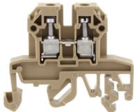
Durchgangsklemme, Schraubanschluss, Montageart: TS 35/7,5 und TS 32, Bemessungsquerschnitt: 2,5 mm<sup>2</sup>, Breite: 5 mm, Farbe: Beige
