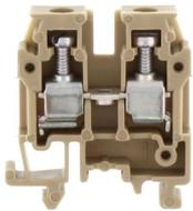
Durchgangsklemme, Schraubanschluss, Montageart: TS 15/5,5, Bemessungsquerschnitt: 2,5 mm<sup>2</sup>, Breite: 5 mm, Farbe: Beige
