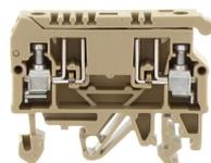
Sicherungstrennklemme, Schraubanschluss, Montageart: TS 35/7,5 und TS 32, Bemessungsquerschnitt: 4 mm<sup>2</sup>, Breite: 8 mm, Farbe: Beige
