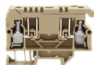
Sicherungstrennklemme, Schraubanschluss, Montageart: TS 15/5,5, Bemessungsquerschnitt: 4 mm<sup>2</sup>, Breite: 8 mm, Farbe: Beige
