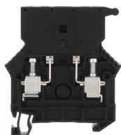
Sicherungsklemme, Schraubanschluss, Montageart: TS 35/7,5 und TS 32, Bemessungsquerschnitt: 10 mm<sup>2</sup>, Breite: 8 mm, Farbe: Schwarz
