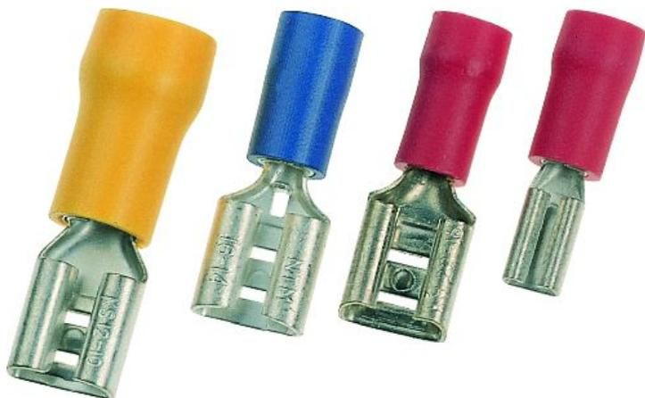
Quetschkabelschuh, Flachsteckform gem. DIN 46245 Teil 1 – 3, Länge: 18,8 mm, Leiterquerschnitt max.: 1,5 mm<sup>2</sup>, Farbe: Rot
