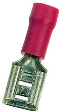
Quetschkabelschuh, Flachsteckform gem. DIN 46245 Teil 1 – 3, Länge: 21 mm, Leiterquerschnitt max.: 1,5 mm<sup>2</sup>, Farbe: Rot
