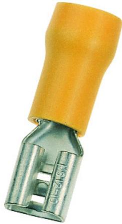
Quetschkabelschuh, Flachsteckform gem. DIN 46245 Teil 1 – 3, Länge: 23,8 mm, Leiterquerschnitt max.: 6 mm<sup>2</sup>, Farbe: Gelb
