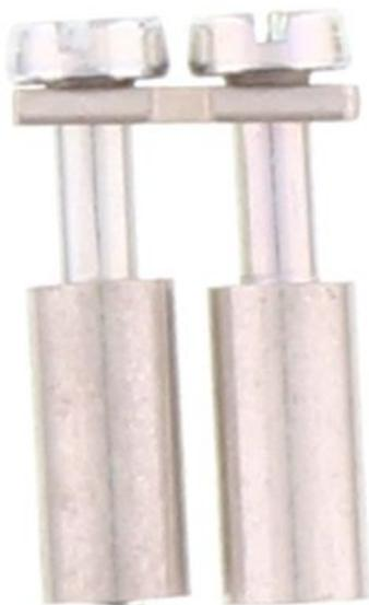
Querverbinder, Polzahl: 2, Montageart: Schraubbar, Breite: 9,1 mm, Bemessungsquerschnitt: 2,5 mm<sup>2</sup>, Farbe: Natur
