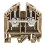
Ex-Durchgangsklemme zertifiziert nach ATEX, Schraubanschluss, Montageart: TS 35/7,5 und TS 32, Bemessungsquerschnitt: 16 mm<sup>2</sup>, Breite: 12 mm, Farbe: Beige
