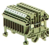
Durchgangsklemme/Blockvariante, Schraubanschluss, Montageart: TS 35/7,5 und TS 32, Bemessungsquerschnitt: 2,5 mm<sup>2</sup>, Farbe: Beige
