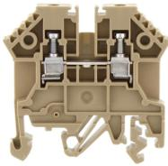
Ex-Durchgangsklemme zertifiziert nach ATEX, Schraubanschluss, Montageart: TS 35/7,5 und TS 32, Bemessungsquerschnitt: 2,5 mm<sup>2</sup>, Breite: 5 mm, Farbe: Beige
