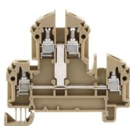
Doppelstockklemme, Schraubanschluss, Montageart: TS 35/7,5, Bemessungsquerschnitt: 4 mm<sup>2</sup>, Breite: 6 mm, Farbe: Beige
