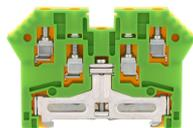
Schutzleiterklemme, Schraubanschluss, Montageart: TS 35/7,5, Bemessungsquerschnitt: 2,5 mm<sup>2</sup>, Breite: 6 mm, Farbe: Grün-gelb
