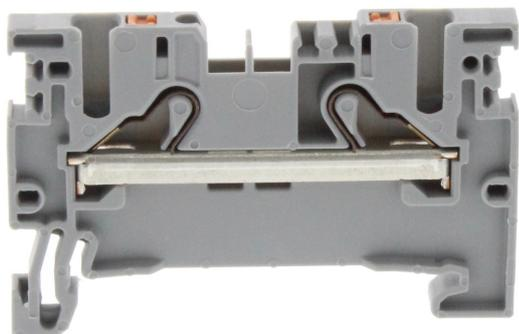
Durchgangsklemme, Push-in-Anschluss, Montageart: TS 35/7,5, Bemessungsquerschnitt: 1,5 mm<sup>2</sup>, Breite: 3,5 mm, Farbe: Grau
