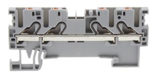
Durchgangsklemme, Push-in-Anschluss, Montageart: TS 35/7,5, Bemessungsquerschnitt: 1,5 mm², Breite: 3,5 mm, Farbe: Grau
