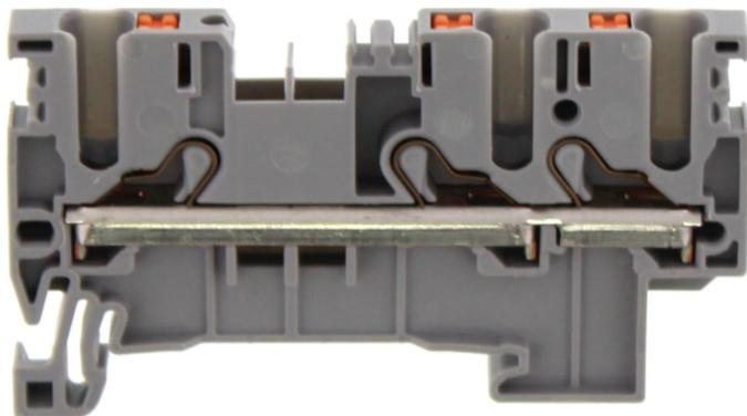
Durchgangsklemme, Push-in-Anschluss, Montageart: TS 35/7,5, Bemessungsquerschnitt: 2,5 mm<sup>2</sup>, Breite: 5,1 mm, Farbe: Grau
