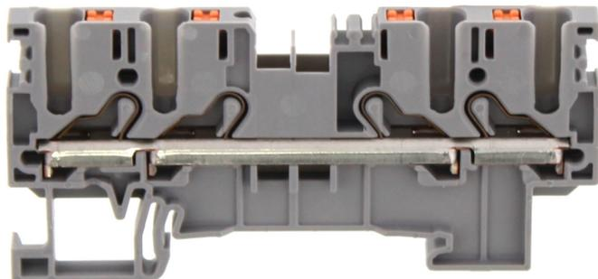
Durchgangsklemme, Push-in-Anschluss, Montageart: TS 35/7,5, Bemessungsquerschnitt: 2,5 mm<sup>2</sup>, Breite: 5,1 mm, Farbe: Grau
