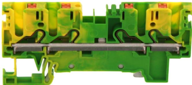
Schutzleiterklemme, Push-in-Anschluss, Montageart: TS 35/7,5, Bemessungsquerschnitt: 2,5 mm<sup>2</sup>, Breite: 5,1 mm, Farbe: Grün-gelb
