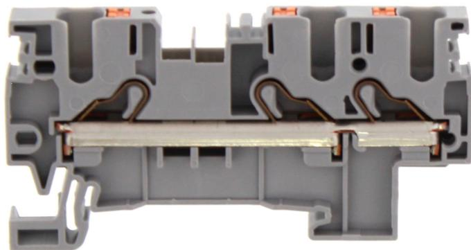
Durchgangsklemme, Push-in-Anschluss, Montageart: TS 35/7,5, Bemessungsquerschnitt: 4 mm<sup>2</sup>, Breite: 6,1 mm, Farbe: Grau
