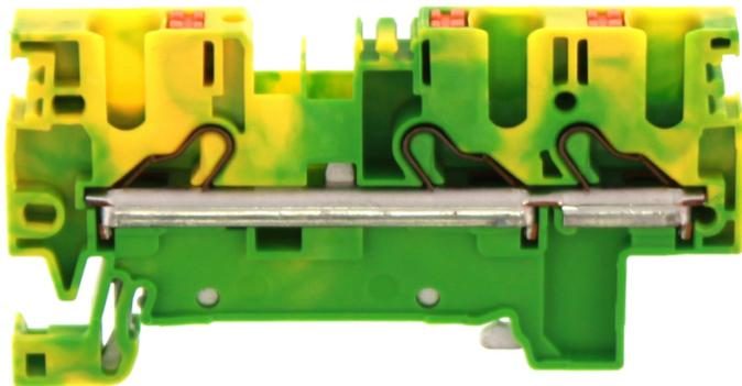
Schutzleiterklemme, Push-in-Anschluss, Montageart: TS 35/7,5, Bemessungsquerschnitt: 4 mm<sup>2</sup>, Breite: 6,1 mm, Farbe: Grün-gelb
