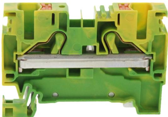
Schutzleiterklemme, Push-in-Anschluss, Montageart: TS 35/7,5, Bemessungsquerschnitt: 6 mm<sup>2</sup>, Breite: 8,1 mm, Farbe: Grün-gelb
