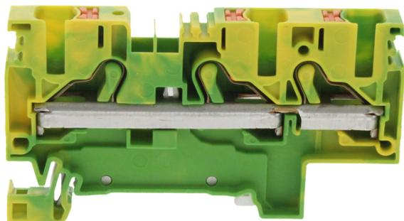
Schutzleiterklemme, Push-in-Anschluss, Montageart: TS 35/7,5, Bemessungsquerschnitt: 6 mm<sup>2</sup>, Breite: 8,1 mm, Farbe: Grün-gelb
