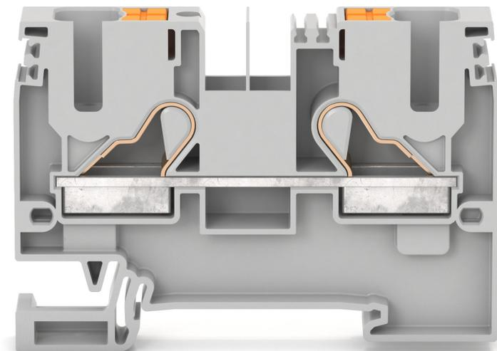
Durchgangsklemme, Push-in-Anschluss, Montageart: TS 35/7,5, Bemessungsquerschnitt: 10 mm<sup>2</sup>, Breite: 10,1 mm, Farbe: Grau
