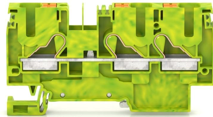
Schutzleiterklemme, Push-in-Anschluss, Montageart: TS 35/7,5, Bemessungsquerschnitt: 10 mm<sup>2</sup>, Breite: 10,1 mm, Farbe: Grün-gelb
