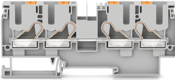
Durchgangsklemme, Push-in-Anschluss, Montageart: TS 35/7,5, Bemessungsquerschnitt: 10 mm<sup>2</sup>, Breite: 10,1 mm, Farbe: Grau
