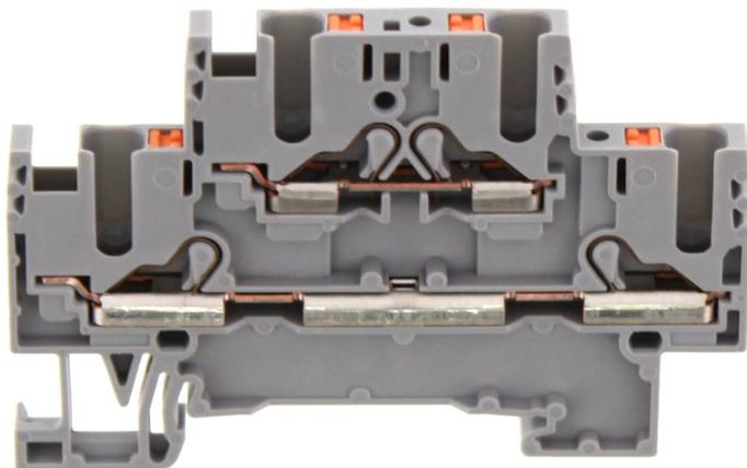
Doppelstockklemme, Push-in-Anschluss, Montageart: TS 35/7,5, Bemessungsquerschnitt: 2,5 mm<sup>2</sup>, Breite: 5,1 mm, Farbe: Grau
