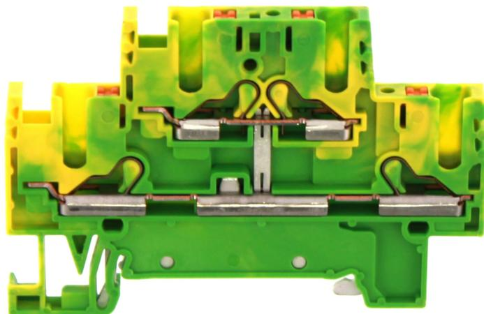
Schutzleiter-Doppelstockklemme, Push-in-Anschluss, Montageart: TS 35/7,5, Bemessungsquerschnitt: 2,5 mm<sup>2</sup>, Breite: 5,1 mm, Farbe: Grün-gelb
