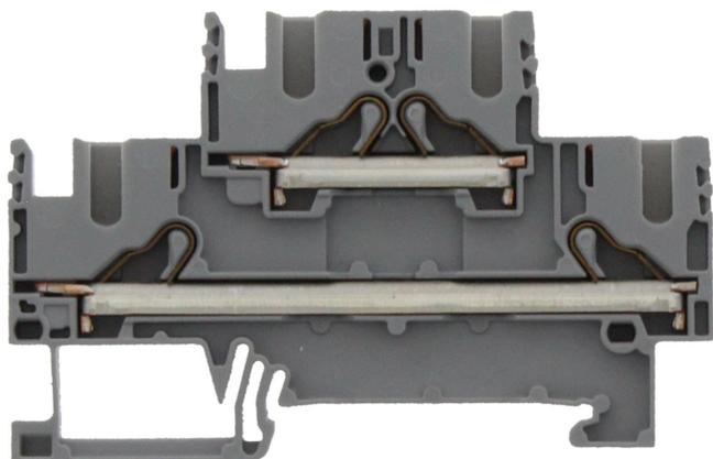
Doppelstockklemme, Push-in-Anschluss, Montageart: TS 35/7,5, Bemessungsquerschnitt: 4,0 mm<sup>2</sup>, Breite: 6,1 mm, Farbe: Grau
