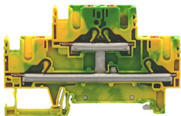
Schutzleiter-Doppelstockklemme, Push-in-Anschluss, Montageart: TS 35/7,5, Bemessungsquerschnitt: 4 mm<sup>2</sup>, Breite: 6,1 mm, Farbe: Grün-gelb
