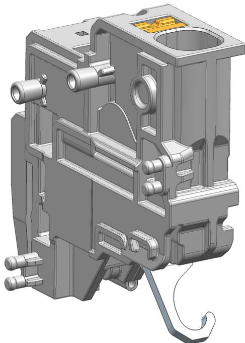
Transformatorklemme zum Anreihen ungerader Polzahlen, Push-in Anschluss, Montageart: Sonderprofile, Bemessungsquerschnitt: 4 mm<sup>2</sup>, Breite: 8,1 mm, Farbe: Grau
