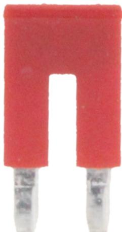
Querverbinder isoliert, Polzahl: 2, Montageart: Stecken, Breite: 10,1 mm, Farbe: Rot
