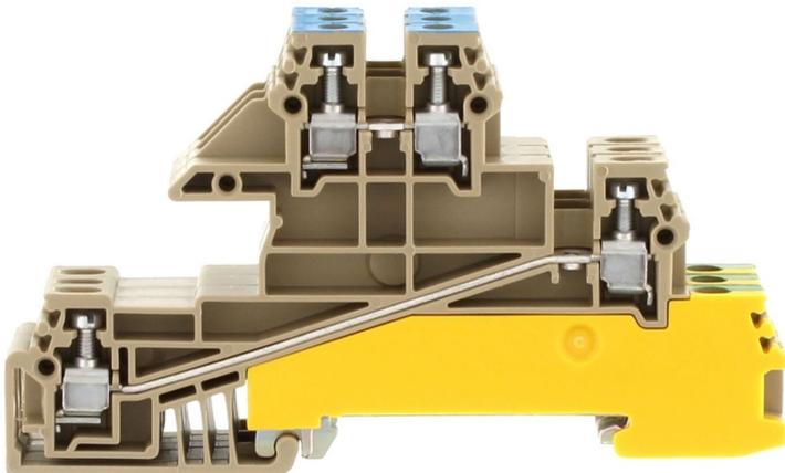
Dreileiter-Installationsklemme, Schraubanschluss, Montageart: TS 35/7,5, Bemessungsquerschnitt: 2,5 mm<sup>2</sup>,
