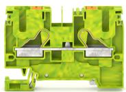
Schutzleiterklemme, Push-in-Anschluss, Montageart: TS 35/7,5, Bemessungsquerschnitt: 10 mm<sup>2</sup>, Breite: 10,1 mm, Farbe: Grün-gelb
