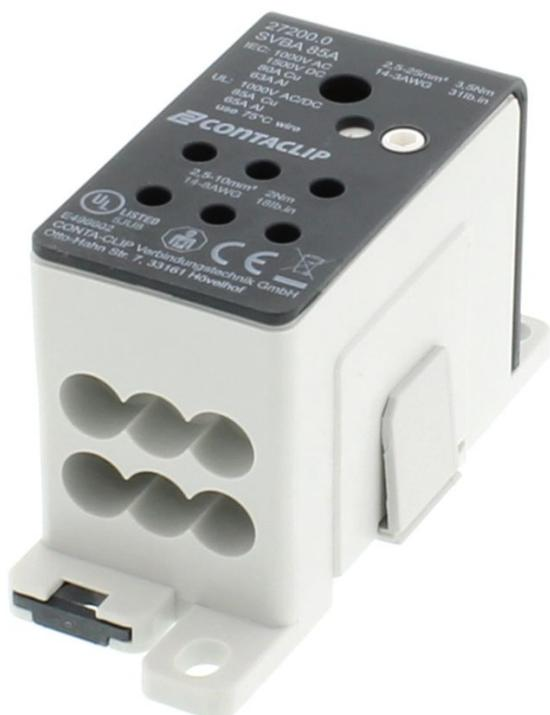
Schraub-Verteiler-Block, Schraubanschluss, Montageart: TS 35/7,5 und Montagefläche, Bemessungsquerschnitt Eingang: 25 mm<sup>2</sup>, Bemessungsquerschnitt Ausgang: 10 mm<sup>2</sup>, Farbe: Dunkelgrau
