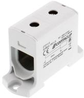
Schraub-Verteiler-Block, Schraubanschluss, Montageart: TS 35/7,5 und Montagefläche, Bemessungsquerschnitt Eingang: 150 mm<sup>2</sup>, Bemessungsquerschnitt Ausgang: 150 mm<sup>2</sup>, Farbe: Lichtgrau
