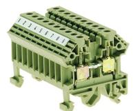
Durchgangsklemme/Blockvariante, Schraubanschluss, Montageart: TS 35/7,5 und TS 32, Bemessungsquerschnitt: 4 mm<sup>2</sup>, Farbe: Beige
