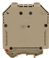
Durchgangsklemme, Schraubanschluss, Montageart: TS 35/7,5 und TS 32, Bemessungsquerschnitt: 150 mm<sup>2</sup>, Breite: 31 mm, Farbe: Beige
