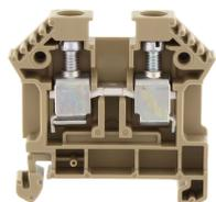
Durchgangsklemme, Schraubanschluss, Montageart: TS 35/7,5, Bemessungsquerschnitt: 10 mm<sup>2</sup>, Breite: 8 mm, Farbe: Beige
