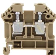
Durchgangsklemme, Schraubanschluss, Montageart: TS 35/7,5, Bemessungsquerschnitt: 10 mm<sup>2</sup>, Breite: 8 mm, Farbe: Beige
