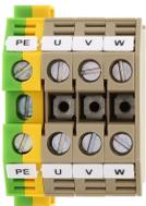
Vierleiter-Motor-Anschlussblock, Schraubanschluss, Montageart: TS 35/7,5 und TS 32, Bemessungsquerschnitt: 10 mm<sup>2</sup>, Farbe: Mehrfarbig
