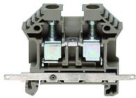
Durchgangsklemme, Schraubanschluss, Montageart: TS 35/7,5, Bemessungsquerschnitt: 10 mm<sup>2</sup>, Breite: 8 mm, Farbe: Beige
