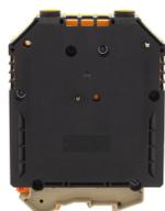
Durchgangsklemme, Schraubanschluss, Montageart: TS 35/7,5 und TS 32, Bemessungsquerschnitt: 240 mm<sup>2</sup>, Breite: 36 mm, Farbe: Schwarz-gelb
