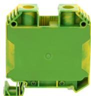
Schutzleiterklemme, Schraubanschluss, Montageart: TS 35/7,5, Bemessungsquerschnitt: 35 mm<sup>2</sup>, Breite: 16,1 mm, Farbe: Grün-gelb
